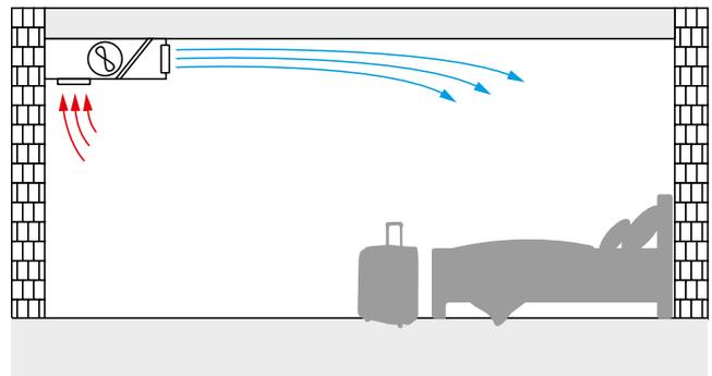
Abb. Hotelschema mit Truhengerät DXC bzw. DXD in Zwischendecke
