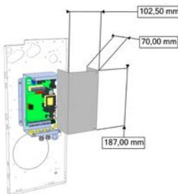
KNX Funktionskarte montiert und verkabelt an Fan Coil
