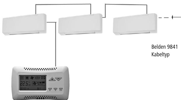
Eine Steuerung für mehrere Einheiten (maximal 20 Einheiten)
