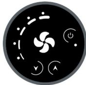
Die Steuerung CB-ECO ermöglicht das Ein- und Ausschalten des Geräts (Standby) und die Regulierung der Lüftung über die Einstellung der Ventilator Drehzahl, während die Temperaturregelung über einen zentralen programmierbaren Thermostat oder einen Thermostat in der Gebäudeleittechnik erfolgt, der nicht nur den Ventilator aktiviert, sondern auch das Öffnen und Schließen des Wasserventils am Anschlussrohr steuert.
