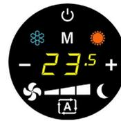
Mit der Regelung CB-Touch kann die Raumtemperatur einfach und intuitiv über einen im unteren Bereich des Geräts angeordneten Fühler geregelt und eingestellt werden.
