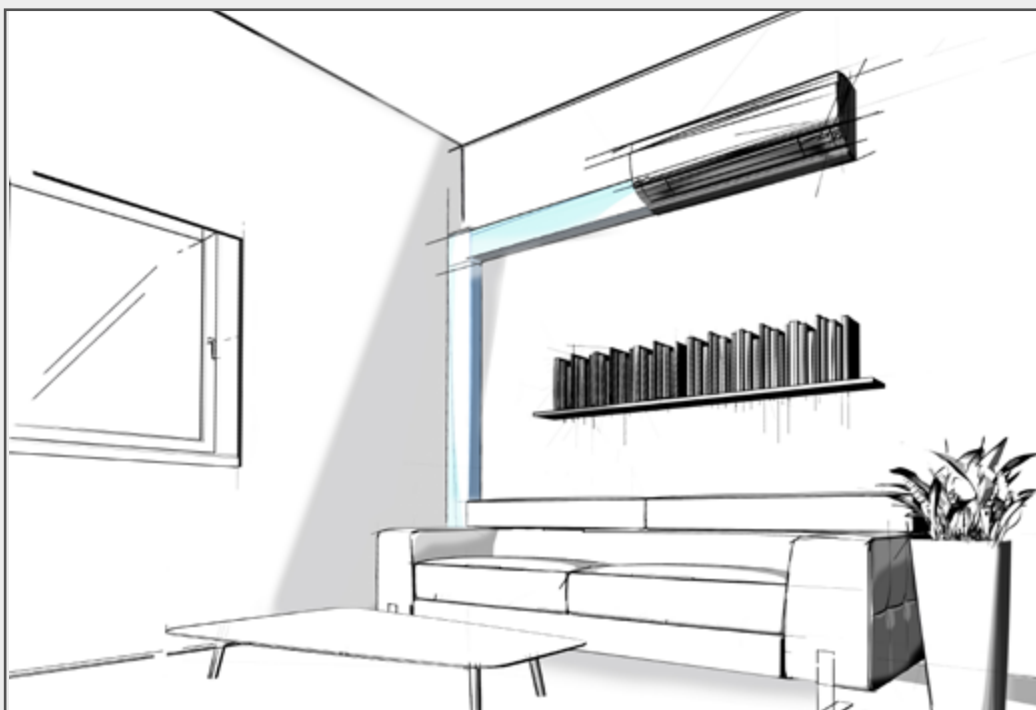
VERKLEIDUNG VON KÄLTELEITUNGEN
