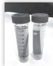
Einfaches Härtemessbesteck für die Gesamthärte und die Karbonathärte, in zwei verschiedenen Ausführungen.
