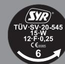
Membran-Sicherheitsventile werden vom Hersteller verplombt, sodass der Einstelldruck ohne Zerstörung der Plombenkappe nicht verändert werden kann. Ist eine Manipulation sichtbar, verliert das Sicherheitsventil seine Zulassung.
