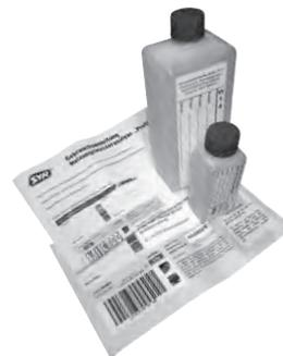
Zwei Fläschchen mit je einem integrierten Stahlplättchen (eines mit HSK 1). Hat das eingefüllte Wasser korrosive Eigenschaften, wird es in der Flasche ohne HSK 1-Zusatz nach zwei Tagen rostig braun.
